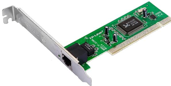
Figura 5.11: Tarjeta de red RTL8139
