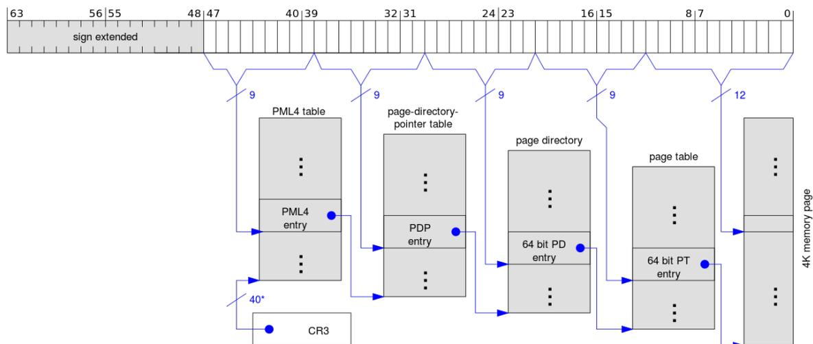
**Figura 5.4:** Proceso de traducción de una dirección virtual (Fuente: Wikimedia)
