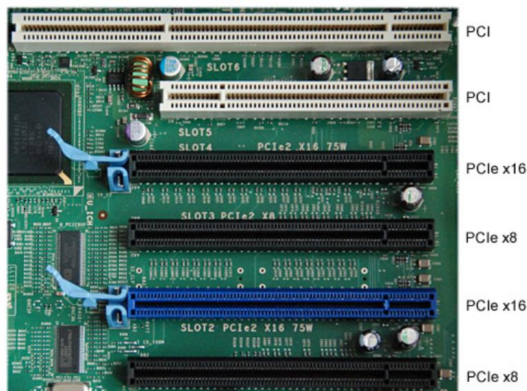
Figura 5.9: Conexiones PCI y PCIe de un ordenador
