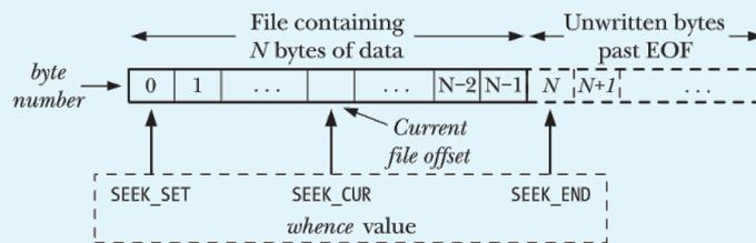
Figura 4.4: Funcionamiento SEEK\_SET, SEEK\_CUR y SEEK\_END [21]
